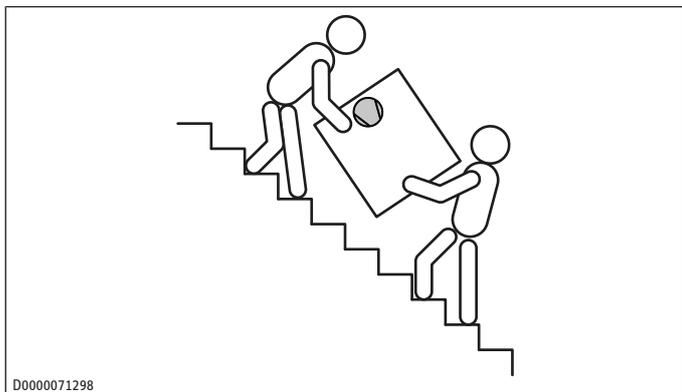
Wenn Sie das Gerät beim Transport ankippen (bis 45°), darf dies nur kurzzeitig über eine der Längsseiten geschehen. Transportieren Sie das Gerät dabei so, dass sich der Verdichter an der höher gelegenen Geräteseite befindet.
